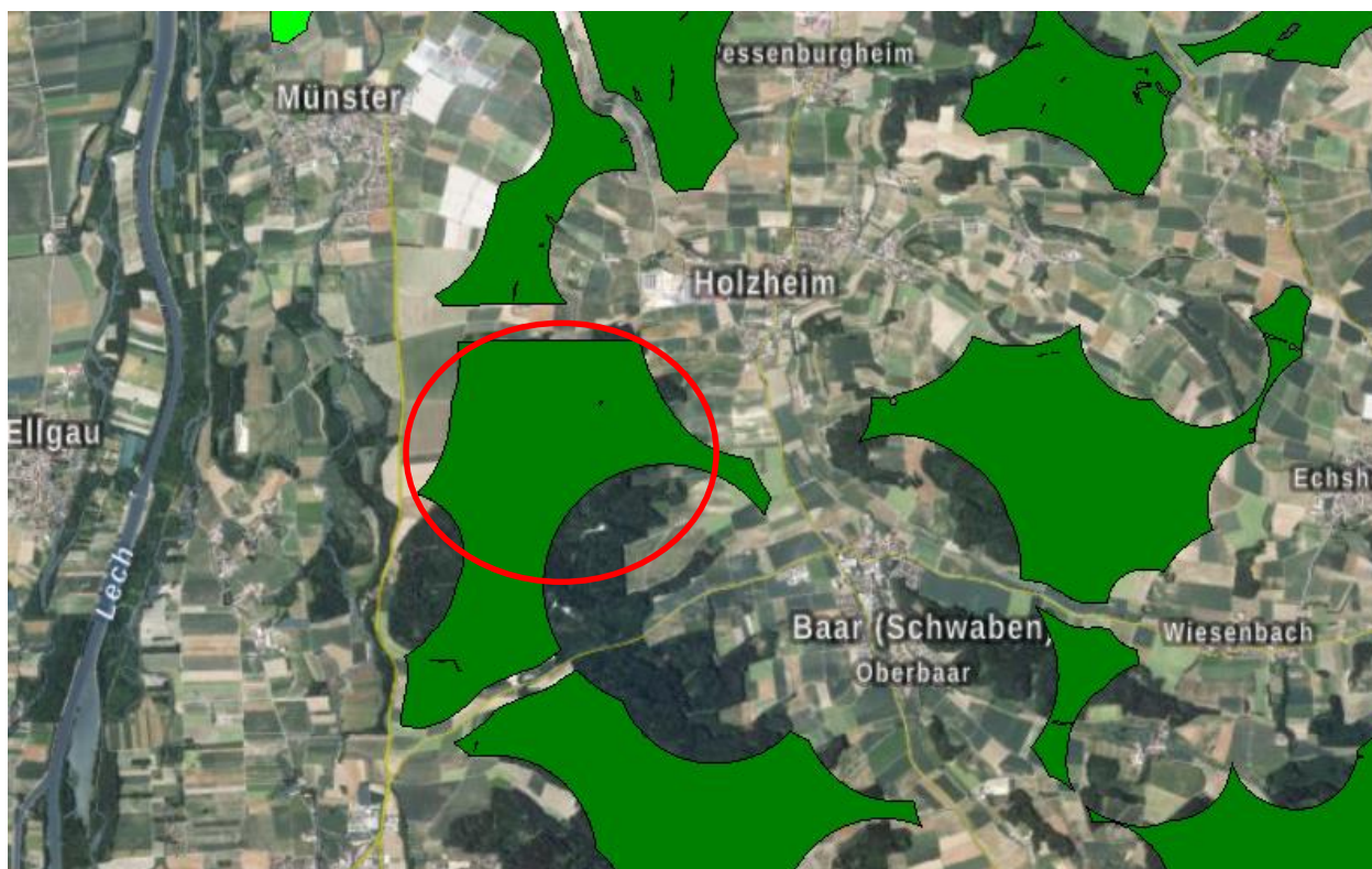
Abbildung 5: Gebietskulisse Windkraft (nur günstige Gebiete); Überwiegend aus Gründen des Immissions- und Naturschutzes für WEA voraussichtlich mögliche Flächen (hellgrün+grün > 10 ha, mittlere Windgeschwindigkeit ab 5 m/s in 130 m Höhe) (© 2022 Bayerische Vermessungsverwaltung)
